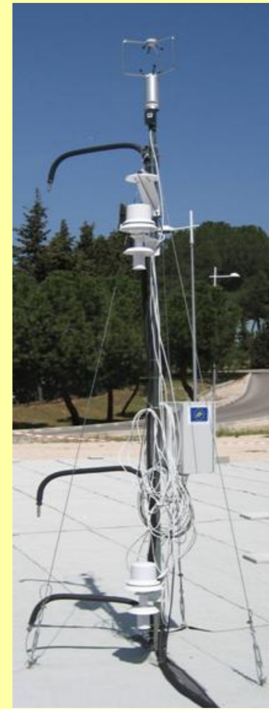
Mástil de la plataforma experimental con sensores meteorológicos y sondas de medida de gases y esquema de la disposición de la instrumentación
